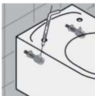
**Montagefreundlich** – direkt durch die Befestigungslöcher des WC-Sitzes lassen sich Wand-WCs mit **PlugFix-System** schnell, sicher und von außen unsichtbar montieren.
